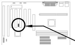
El conector SB-LINK se puede usar para la conexión de la tarjeta de sonido Creative-compatible PCI. Si Ud. cuenta con una tarjeta de sonido Creative-compatible PCI, será necesario conectar la tarjeta a este conector para la compatibilidad de DOS.
