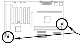
Enchufa el cable del ventilador a **FAN CPU** de 3 pinzas o el conector de **FAN**. Los 2 conectores de ventilador apoyan la función del monitor. Sin embargo, Ud. puede usar solamente el conector de ventilador CPU para el control del ON/OFF del ventilador.
