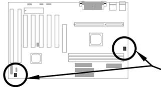
Collegare il cavo del ventilatore al connettore **CPU FAN** o **FAN** da 3 pini. Questi due connettori ventilatore supportano la funzione di monitoraggio dell'hardware. Comunque, è possibile do usare solamente il connettore CPU FAN per controllare l'alimentazione ON/OFF del ventilatore.
