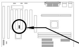
Il connettore SB-LINK può essere usato per il collegamento della scheda audio PCI compatibile con Creative. Se fosse stata installata una scheda audio PCI compatibile con Creative nel Suo sistema, è necessario di collegare la scheda a questo connettore per evitare un problema di compatibilità sotto l'ambiente di DOS.
