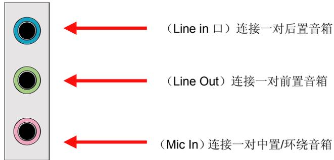
Line Out 口上接一对前置主音箱，在 Line In 口上接一个后置音箱，在 Mic In 口上接一个中置环绕音箱。
