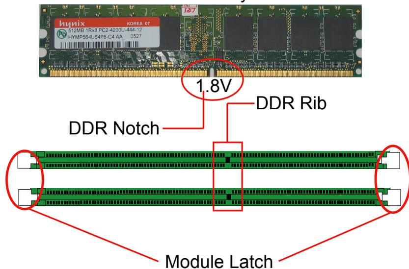
注意内存条和 DIMM 插槽上的防呆口的方向的一致性。
