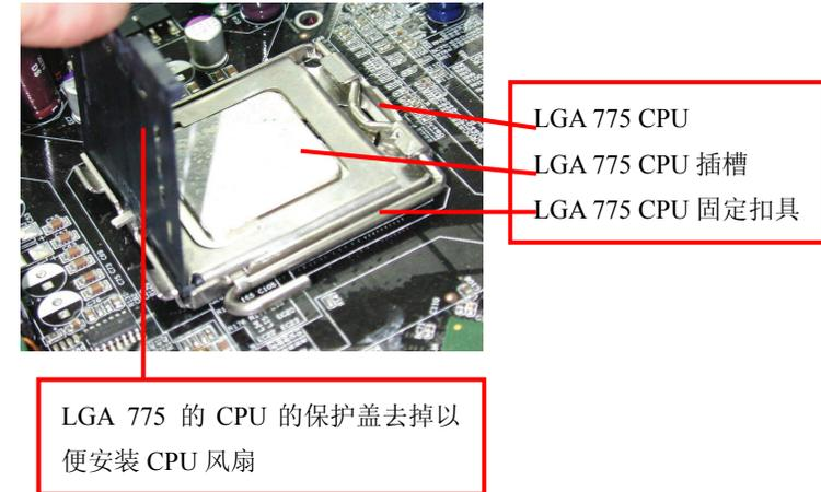
B: 如下图所示: CPU 插座旁边有四个固定孔是用来固定风扇的。将风扇固定脚插进固定孔固定即可。将风扇连接到主板的红色的 4 针接头 FAN1。
