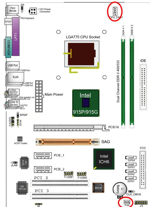
CPU-FAN1 是具有控制、侦测转速功能，专门用来连接 CPU 的风扇。PFAN 风扇接头可以连接系统/机箱风扇，它们是一个 3PIN 的连接头，当将风扇连接线连接到风扇连接头上时，使用者必须将红色的线连接到+12V 的电源上，黑色的线通常是地线即将此线连接到地线上。主板上的风扇接头支持风扇转速侦测功能，可在 BIOS 内观察风扇转速。
