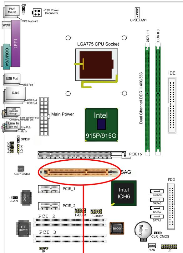
此 SAG 插槽不是 AGP 插槽，由 PCI 总线信号转换，只可以使用部分 AGP 显卡
