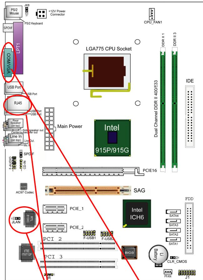
RJ45/RTL8100C/JLAN 跳线
