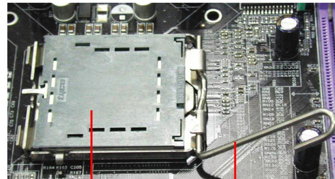
CPU 插槽的保护盖, 用来保护 CPU 插槽的金属圆点
