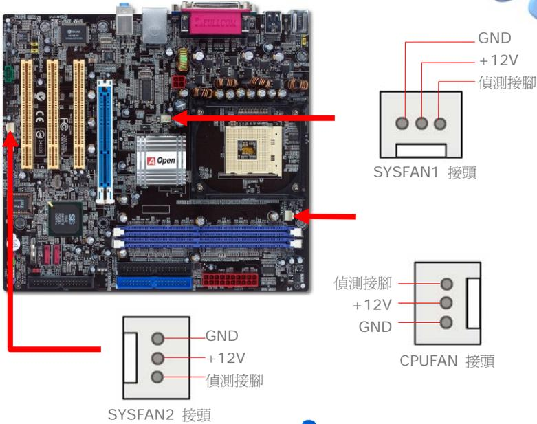
**備註：**部分CPU風扇並沒有轉速偵測接腳，所以無法使用風扇轉速監控之功能。
