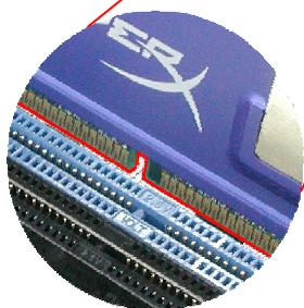
**備註：** 當DIMM模組完全插入插槽時，插槽兩邊的卡榫會自動卡入DIMM兩側以固定該模組。
