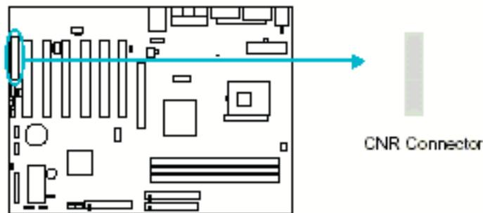
Al utilizar el audio codec, el enlace digital de AC'97 proporcionado por CNR permite una solución de bajo coste y de alta calidad para el audio integrado. Además, se puede utilizar también un "soft-modem" AC'97 con modem codec. AC'97 Digital Link permite la conexión de multitud de codecs. El enlace digital soporta dos codecs de audio para hasta 6 canales de salida de audio PCM (decodificación AC-3 completa) o una combinación de codec de audio y de modem.
