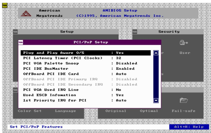
Fig. 20 PCI/PnP Setup Menu
