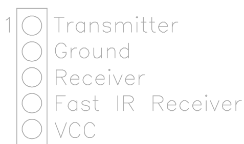
Fig. 8 J9 - Optional IrDA and Fast IR Connector
