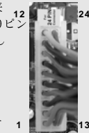
20ピン ATX 電源装置の取り付け
