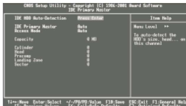
Figura 2-1 Menu de configuración del IDE primario Master
