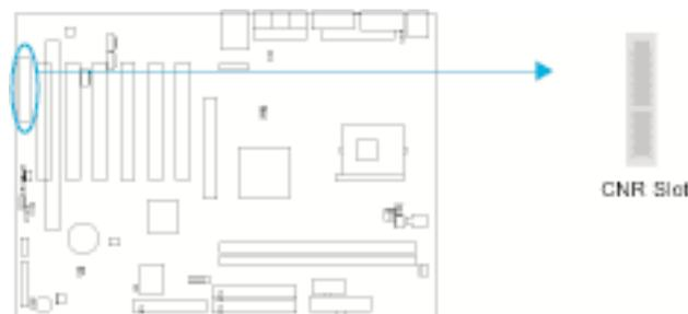
Al utilizar el audio codec, el enlace digital de AC'97 proporcionado por CNR permite una solución de bajo coste y de alta calidad para el audio integrado. Además, se puede utilizar también un "soft-modem" AC'97 con modem codec. AC'97 Digital Link permite la conexión de multitud de codecs al ICH2. El enlace digital soporta dos codecs de audio para hasta 6 canales de salida de audio PCM (decodificación AC-3 completa) o una combinación de codec de audio y de modem.
