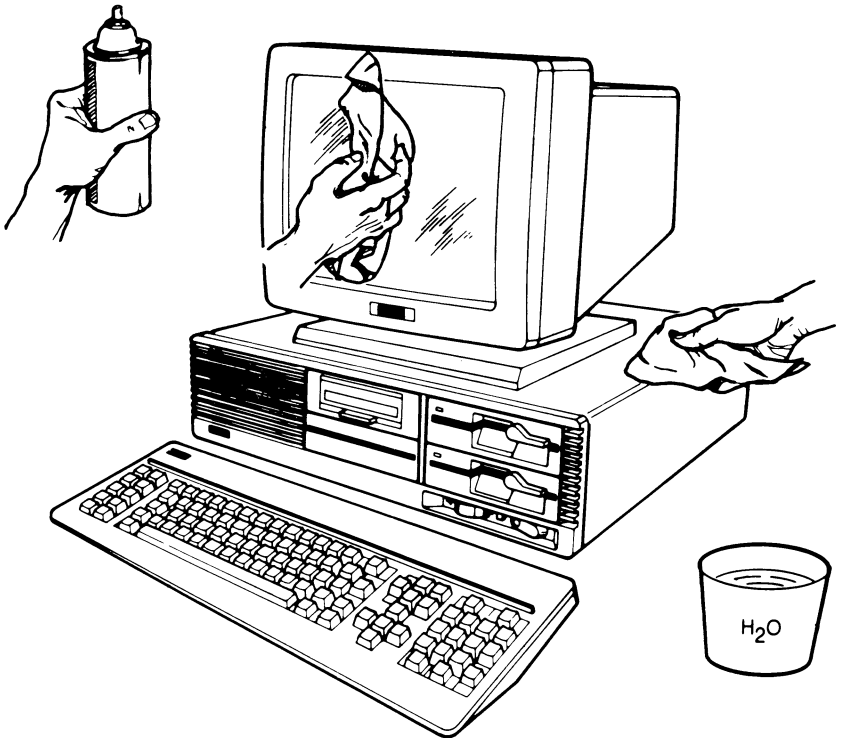
Abbildung 3-6 Reinigen des Systems
