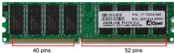
2. 將記憶體模組置入插槽中，雙手略為施力下壓，確定記憶體模組已固定於插槽中。
