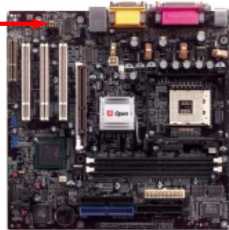
**Anmerkung:** Entfernen Sie vor Anschluss des Kabels bitte die Jumperkappen des Frontplatten-Audioanschlusses. Entfernen Sie diese gelben Jumperkappen nicht, wenn Ihr Computergehäuse über keinen Frontplatten-Audioanschluss verfügt.
