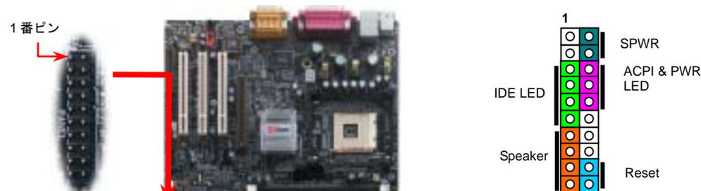
電源 LED、スピーカー、リセットスイッチのコネクタをそれぞれ対応するピンに差し込んでください。BIOS セットアップで "Suspend Mode" の項目をオンにした場合は、ACPI 及び電源の LED がサスペンドモード中に点滅します。
