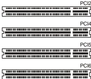
J9, J10 : 64bit 66MHz PCI 插槽
