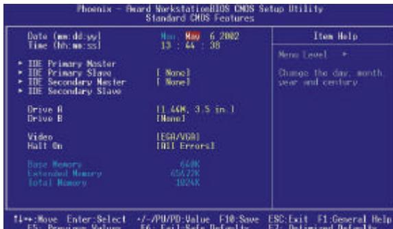
在標準CMOS參數的設定中，共有日期，時間，硬式與軟式磁碟機的設定它@14類。利用方向鍵，Enter鍵，以及<PgUp> / <+>鍵與<PgDn> / <->鍵來更改每一個項目的設定值。
