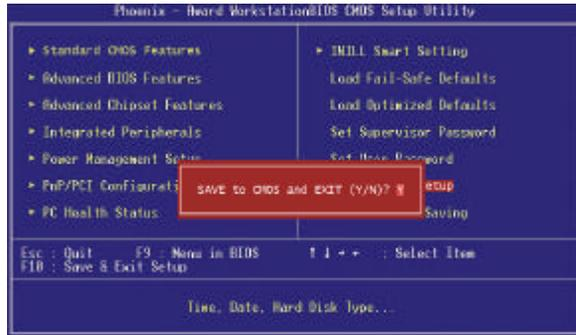
當選擇Save & Exit Setup設定時，按下<Enter>鍵後，畫面顯示下列訊息“ Save to CMOS and Exit(Y/N)? N”此時按下<Y>鍵後，就會儲存設定值並離開BIOS設定程式。系統亦可在BIOS設定完成後直接按下<F10>鍵即顯示上述顯示畫面後，按下<Y>鍵，亦可儲存設定值並離開BIOS設定程式。
