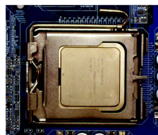
図 4 CPU が適切に挿入された後、ロードプレートを元に戻し、金属レバーを元の位置に押し戻します。
