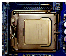
圖4. 確定中央處理器安裝正確後，請將金屬上蓋蓋回，並將插座連桿向下壓回至鎖住的位置。
