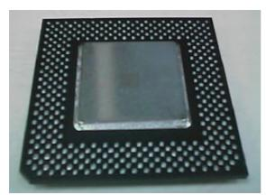
Figure 1: INTEL® Celeron<sup>TM</sup> Socket370 Processor
