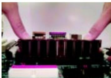
1. Le socle DDR possède une encoche asymétrique, afin que le module mémoire DIMM ne puisse être inséré que dans un sens.
