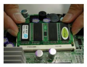
Step 2: Press Module down till clip hold.
