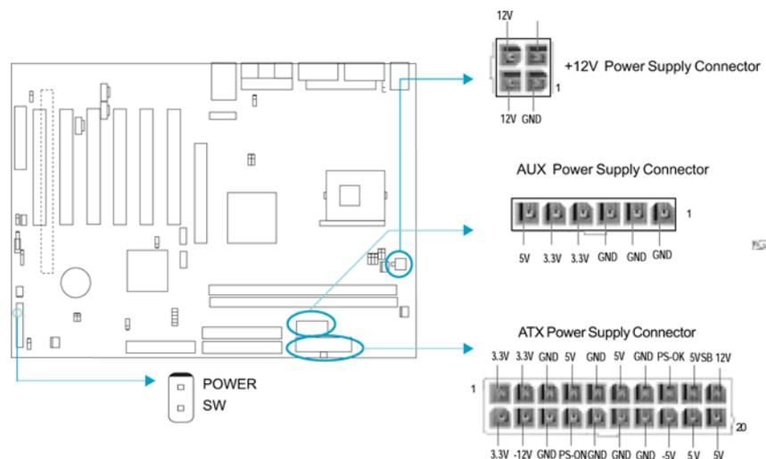
Note : (1) Si la valeur utilisée par défaut « Instant-off » de la ligne de commande nommée "soft-off by PWR-BTTN" du menu de BIOS nommé « Power Management Setup » par la valeur « Delay 4 Sec », l'interrupteur de fonctionnement doit être maintenu pressé pendant une durée de 4 secondes afin que le système s'arrête.
