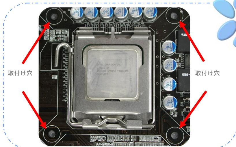
2. 4本のスティックを1本ずつ取付け穴に挿します。スティックが穴に着実に固定されていることを確かめてください。
