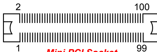
Mini PCI Socket pin orientation
