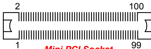
Mini PCI Socket pin orientation
