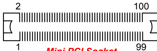
Mini PCI Socket pin orientation
