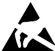
Baugruppen mit elektrostatisch gefährdeten Bauelementen (EGB) können durch den abgebildeten Aufkleber gekennzeichnet sein:
