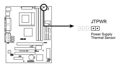
**CUV4X-ME Thermal Sensor Connector**
