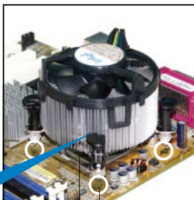
主板孔位 散热器与风扇的 下推式固定扣具
