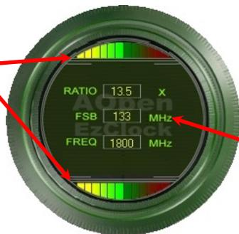
左邊的圓狀畫面中顯示 CPU 的倍頻、FSB 及頻率資訊。當設定為原廠預設值時，畫面上方及下方的色條圖停留在綠色處。此色條圖將隨著 CPU 設定值的變化而顯示不同的顏色。
