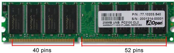
**說明：**若您打算使用雙通道模式，請將記憶體安裝於相同顏色之插槽中，(DIMM A1 與 DIMM B1)或是(DIMM A2 與 DIMM B2)。請使用相同運作時脈之記憶體模組。
