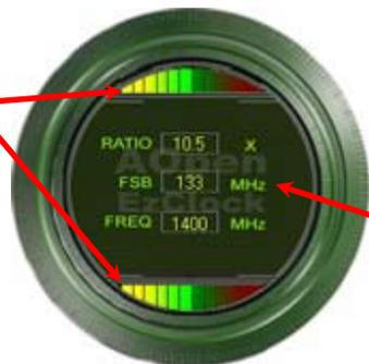
位於左方的環形視窗中能顯示目前的倍頻、外頻與 CPU 時脈。當 CPU 的狀況符合預設值時，CPU 色帶指示將顯示「綠色」，顯示顏色將依設定值不同而改變。
