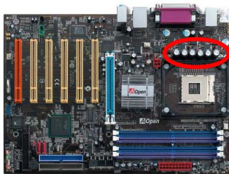
供給 CPU 的核心電壓更需經嚴密控制，讓系統在高頻工作環境中仍能穩定運作。舊型 CPU 的核心電壓為 2.0 伏特，因此能將電壓控制在 1.860V 到 2.140V 之間才能夠提供您穩定運作的保障，電壓增減範圍最多僅能有 280mV，下圖中所示為在 18 安培的供電情形下，僅有 143mV 的增減範圍。
