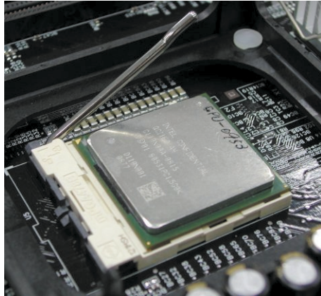
CPUソケットレバーを押し込んで、90度倒し、元の位置に戻します
