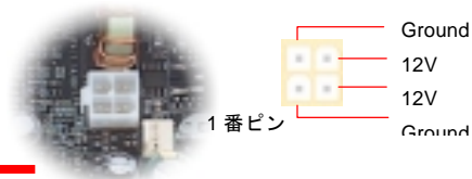
4 ピン 12V ATX 電源コネクタ
