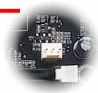
CPU 散熱風扇電源接頭
