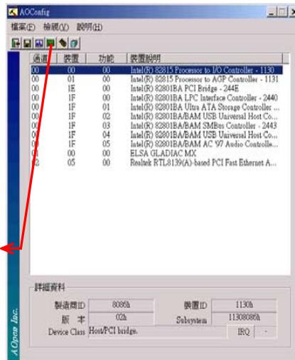
2. 在 PCI 設備資訊頁中可以了解各項 PCI 設備的系統配置情形。
