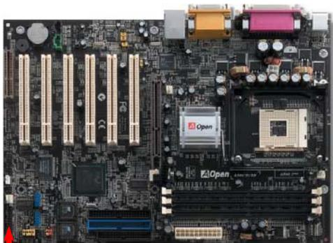
請您對照下方左圖標示，將電源指示燈、PC 喇叭、Reset 按鈕之接線連接至正確位置。若是您已在 BIOS 設定中開啓“待命模式”，當您的電腦進入待命模式時，ACPI 指示燈以及電源指示燈將會持續閃爍。
