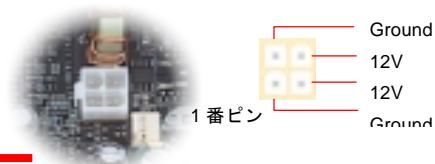
4 ピン 12V ATX 電源コネクタ
