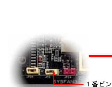
JP2 によるスピーカー/ブザー の設定ジャンパー
