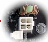
4 ピン 12V ATX 電源コネクタ
