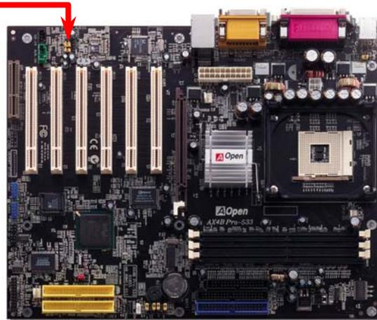
**備註：**在您連接排線至此接腳前，請將接腳上之跳線帽移除。當您未連接前方面板音效擴接腳排線時，則請勿將黃色跳線帽移除。
