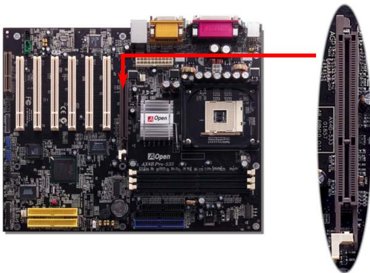
**警告：**我們強烈建議您勿安裝 3.3V 規格之 AGP 卡，Intel 845E 並不支援此種規格。在這種情況下，LED3 會亮起以警告您過度電壓可能造成的損壞。
