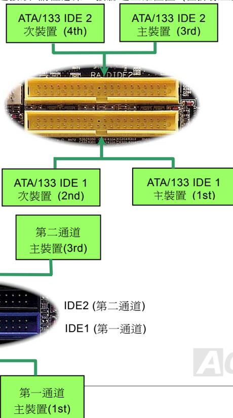
IDE1 為第一通道，而 IDE2 為第二通道。一個 IDE 通道可以支援 2 個 IDE 裝置，所以 2 個通道就可以支援 4 個裝置；由於同一通道上裝置都連接在同一條排線上，所以裝置必須依設定區分成主裝置（Master）及次裝置（Slave）。任何一個 IDE 裝置可以是一台硬碟或是光碟機。至於該裝置是主裝置（Master）還是次裝置（Slave）就依照該裝置之跳線而決定，此部分請參考您的硬碟機或是光碟機的說明書。
