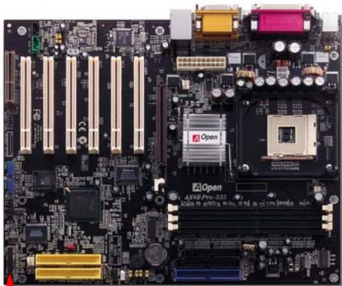
將電源指示 LED, Keylock 鎖鍵, PC 喇叭, 電源及 Reset 重置開關之接線分別連接至相對之接腳。如果您在 BIOS 設定中開啓“[待機模式 Suspend Mode](#)”項目, 當系統進入待機模式時, 電源燈及待機指示燈將持續閃爍。
