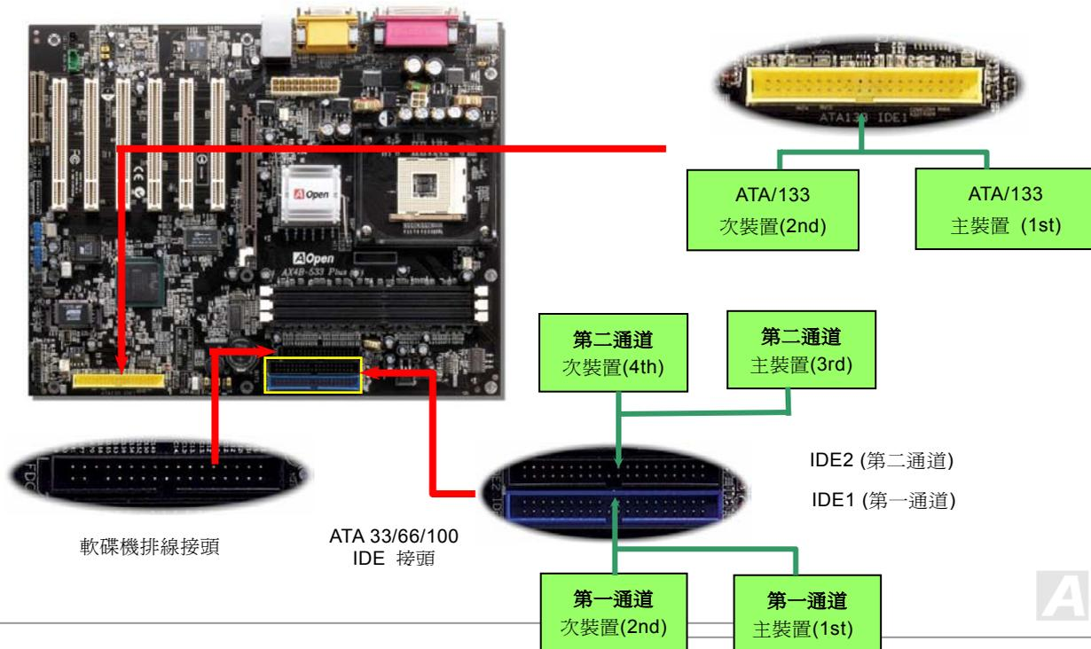
IDE1 為第一通道，而 IDE2 為第二通道，每個 IDE 通道可連接使用二組 IDE 裝置，因此具備雙通道的 AX4B-533 Plus 可支援高達四組 IDE 裝置；由於單一通道上可連接兩組 IDE 裝置，必須將其分別設定為主裝置 (**Master**) 及次裝置 (**Slave**)。您可以任意搭配 IDE 硬碟或是光碟機，再以 **Jumper** 設定來區分主裝置/次裝置。有關於此部分的設定，請參考您的硬碟機或是光碟機安裝手冊。
