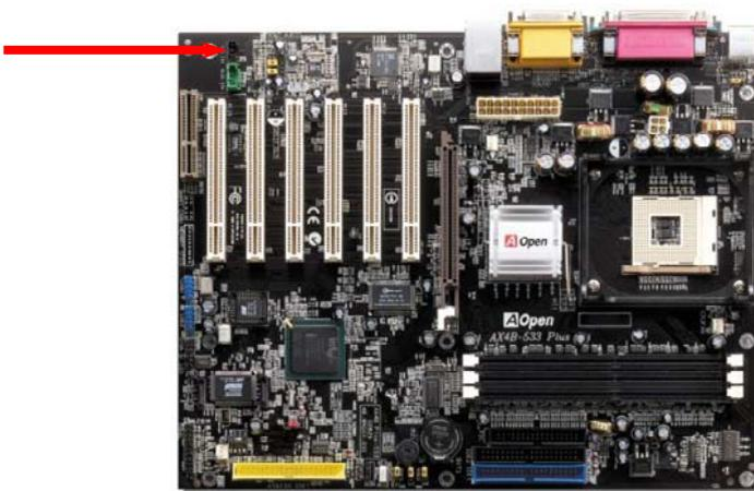
**說明：**雖然較新版本的 Windows 作業系統已提供“Digital Audio”的功能(藉由 IDE 排線輸出)，然而為了搭配能在 BIOS 中執行“Open Jukebox 播放器”，請您**務必**安裝音源線。
