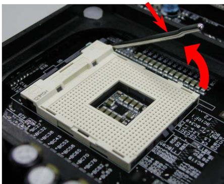
2. 確定 CPU 第一針腳位置(在 CPU 正面角落印有金三角標誌以供識別)，使其配合插槽方向(如圖中紅色圓圈所示)，置入後輕壓至底，確定 CPU 針腳完全吻合。
