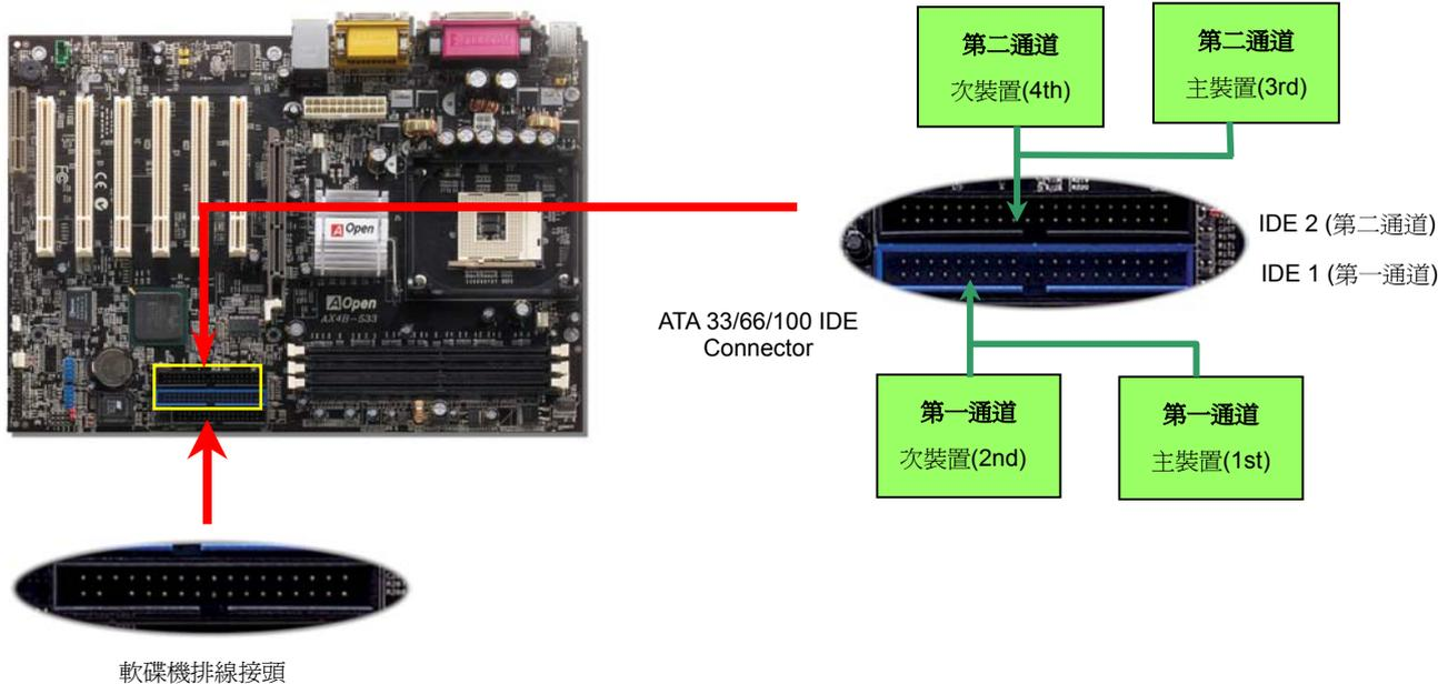
IDE1 為第一通道，而 IDE2 為第二通道，每個 IDE 通道可連接使用二組 IDE 裝置，因此具備雙通道的 AX4B533/AX4B533N 可支援高達四組 IDE 裝置；由於單一通道上可連接兩組 IDE 裝置，必須將其分別設定為主裝置 (**Master**) 及次裝置 (**Slave**)。您可以任意搭配 IDE 硬碟或是光碟機，再以 **Jumper** 設定來區分主裝置/次裝置。有關於此部分的設定，請參考您的硬碟機或是光碟機安裝手冊。本款主機板可使用 [ATA 33/66/ATA100](#) 傳輸模式，以下為您列出詳細的傳輸模式規格：
