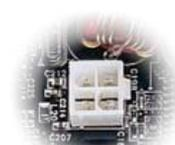
4-Pin 12V ATX 電源接頭
