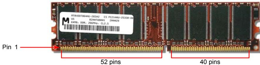
2. 將記憶體模組置入插槽中，雙手略為施力下壓，確定記憶體模組已固定於插槽中。
