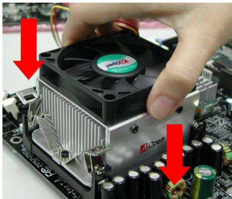
2. 將卡榫一一壓入勾槽中，固定散熱風扇。
