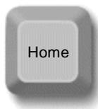
ヒント: オーバークロックにより、システム起動に失敗してフリーズした場合は、<Home>キーを押すだけで初期値設定(433MHz)に戻ることができます。あるいは、AOpen "Watch Dog Timer"がシステムを再起動するのを五秒間待ってれば、システムがハードウェアを再び自動検査します。
