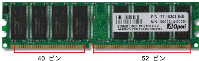
2. DIMM ソケットにモジュールを両手でまっすぐ下方に DIMM モジュールが止まるまで差し込みます。
