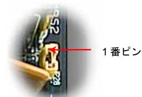
JP28 によるキーボード/マウスウェイクアップ機能の設定ジャンパー
