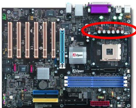
供應 CPU 核心電壓的電源電路一定要能確保 CPU 在高頻工作時的穩定性 (例如高頻工作的 Pentium III，或是當您超頻時)。典型的 CPU 核心電壓為 2.0V，所以一個好的設計必須將電壓控制在 1.860V 至 2.140V 之間，瞬間電壓則須低於 280mV。以下的圖形是由數位式示波器所截取下來的畫面，圖中顯示：即使接上高達 60A 的強大電流時，瞬間電壓也能控制在 143mV。
