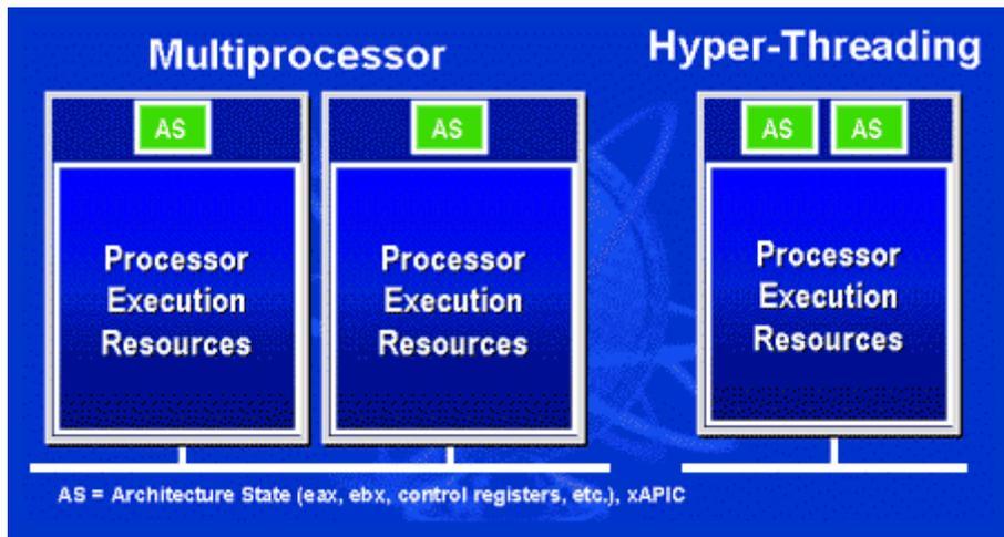
對於支援多處理器的應用程式而言，具備高速執行緒功能的處理器就像是兩個各自獨立的邏輯處理器一樣，程式可以直接在此架構下執行，不需做任何修改。而每個邏輯處理器可單獨對中斷處理做出回應。兩個邏輯處理器可以同步處理兩個不同的執行緒，而這兩個執行緒卻是共享處理器的工作資源。當一顆處理器只處理一個執行緒時，工作資源經常會閒置著，但若這顆處理器劃分成了兩個邏輯處理器，閒置下來的工作資源就可以去處理第二個執行緒的需求。因此整體來說，這顆處理器的工作資源使用率就大幅提高了。
