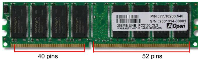
2. 利用雙手將記憶體模組垂直往下壓，並稍加用力一直到 DIMM 模組穩穩裝入插槽中。
