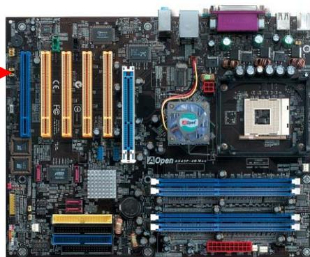
**メモ:** ケーブルを接続する際には、フロントパネルオーディオコネクタからジャンパーキャップを外してください。筐体のフロントパネルにオーディオポートがない場合は黄色いジャンパーキャップを外さないでください。
