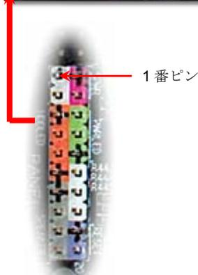
フロントパネルコネクタは機能に応じて異なる色分けとなっています。電源 LED、スピーカー、電源、リセットスイッチのコネクタをそれぞれ対応するピンに差します。BIOS セットアップで“Suspend Mode” の項目をオンにした場合は、ACPI および電源の LED がサスペンドモード中に点滅します。
