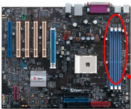
**備註：**依據 JEDEC (Joint Electron Device Engineering Council, 聯合電子裝置工程協會) 所訂定的標準 DDR400 規格限定 DDR400 只支援 2x DIMM 記憶體模組最大容量至 2GB，而 DDR333 最多可支援 3x DIMM 模組最大容量至 3GB。請注意 AK89 Max / AK89-L / AK89-N 系列主機板也遵守此記憶體標準規則。
