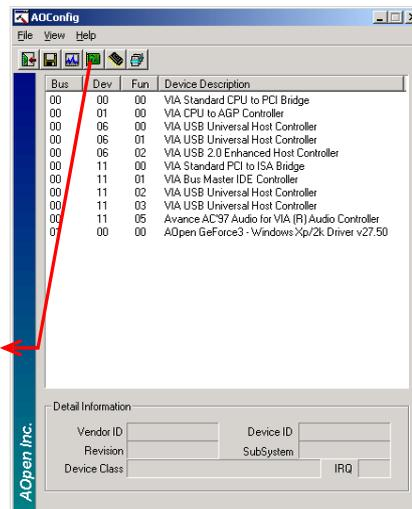
2. 【PCI 裝置】頁面提供您主機板上安裝的所有 PCI 裝置的設定資訊。
