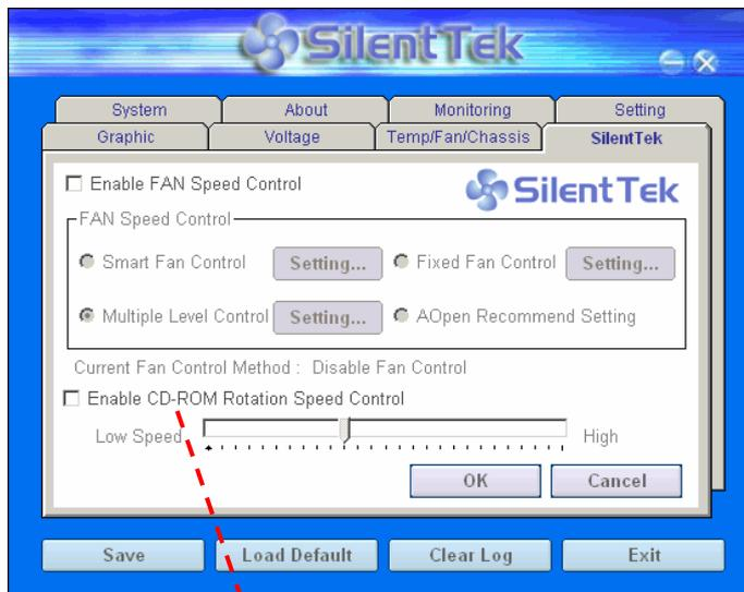
**CD-ROM Rotation Speed Control:** 使用此 CD-ROM 轉速控制選項，您就可以控制光碟機轉速來降低噪音。如果將轉速設定為 High，則 CD-ROM 將以全速運作，而如果設為 Low Speed 則只會以基本速度運轉。
