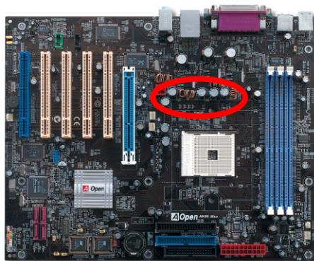
供應 CPU 核心電壓的電源電路一定要能確保 CPU 在高頻工作時的穩定性（例如高頻工作的 Pentium III，或是當您超頻時）。典型的 CPU 核心電壓為 2.0V，所以一個好的設計必須將電壓控制在 1.860V 至 2.140V 之間，瞬間電壓則須低於 280mV。以下的圖形是由數位式示波器所截取下來的畫面，圖中顯示：即使接上高達 60A 的強大電流時，瞬間電壓也能控制在 143mV。
