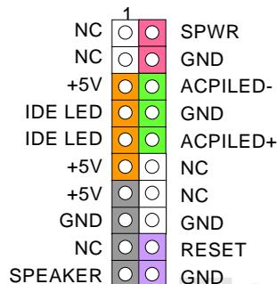
將電源指示 LED、喇叭、電源及 Reset 重置開關之接線分別連接至相對之接腳。如果您在 BIOS 設定中開啓“待機模式 Suspend Mode”項目，當系統進入待機模式時，電源燈及待機指示燈將持續閃爍。
