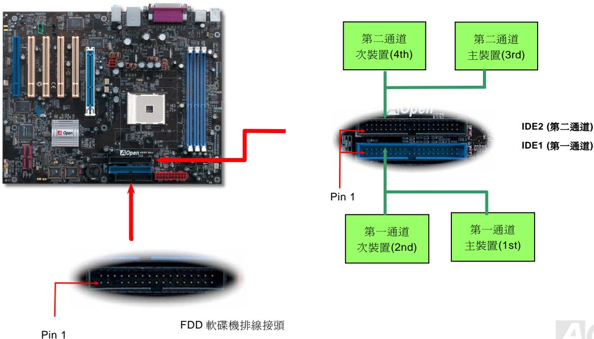
IDE1 為第一通道，IDE2 為第二通道。每一個 IDE 通道可以支援 2 個 IDE 裝置，所以 2 個通道就可以支援 4 個裝置；由於同一通道上裝置都連接在同一條排線上，所以裝置必須依設定區分成主裝置（Master）及次裝置（Slave）。任何一個 IDE 裝置可以是一台硬碟或是光碟機，至於該裝置是主裝置（Master）還是次裝置（Slave）就依照該裝置之跳線而決定。此部分請參考您的硬碟機或是光碟機的說明書。
