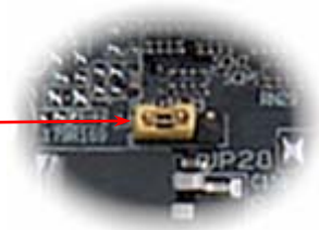
JP28 によるキーボード/マウスウェイクアップ機能の設定ジャンパー
