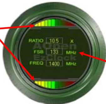
位于左方的环形窗口中能显示目前的倍频、外频、CPU 时钟。当 CPU 的状况符合默认值时，CPU 色带指示将显示「绿色」，显示的颜色将按照设定值不同而改变。
