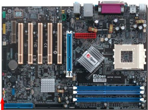
将电源指示 LED、PC 喇叭、电源及 Reset 重置开关的接线分别连接到相对的接脚。如果您在 BIOS 设定中开启“待机模式 Suspend Mode”选项，当系统进入待机模式时，电源灯及待机指示灯将持续闪烁。
