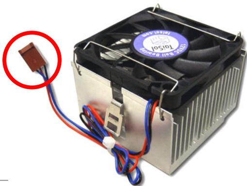
**Nota:** E' necessario usare una ventola di raffreddamento CPU a 3-pin con questa scheda madre. Solo le ventole a 3-pin supportano la funzionalità di controllo hardware.
