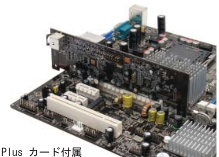
PCIe x16 スロットにあるオプション ADD2 Plus カード付属
