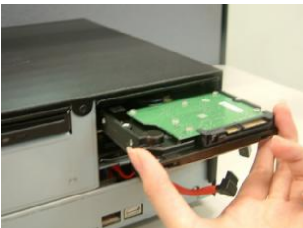
e. Remove the HDD.
